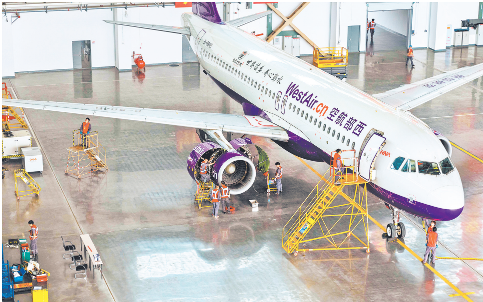
重庆江北国际机场E2机库,海航航空技术(重庆)有限责任公司的技术人员在拆解飞机,拆卸下的部件经严格检测后将作为航材循环利用。该项目规划未来5年将配套建设全国领先的航空资源循环利用基地、区域二手航材交易中心等。(资料图) 重庆日报记者 崔力 摄
