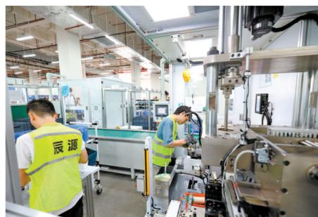
近年来,沙坪坝区以科技创新引领产业转型升级,加快培育和发展新质生产力,打造智能网联新能源汽车产业集群。为加快智能网联新能源汽车产业发展,一批企业围绕汽车生产链条,持续加大科研投入,深耕行业细分领域,做精做强,打造自身“硬核”实力。图为位于沙坪坝区的重庆澳英汽车科技有限公司,工人正在生产线加工汽车电动脚踏板。该公司主要进行汽车电动脚踏板产品的研发和生产,目前正在试生产阶段。
