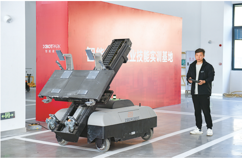
甘庆峰现场操作条板安装机器人。巴渝都市报记者 蒋沛洋 摄
