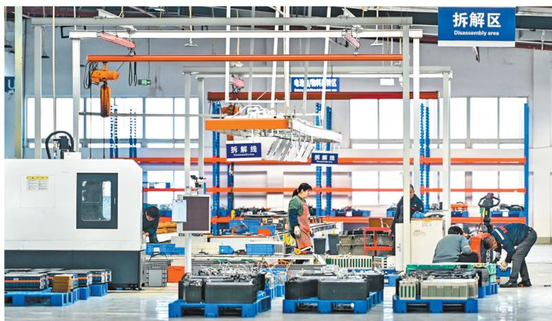
2月28日，潼南区汽车回收利用产业园内，工作人员在进行新能源汽车的电池拆解。
