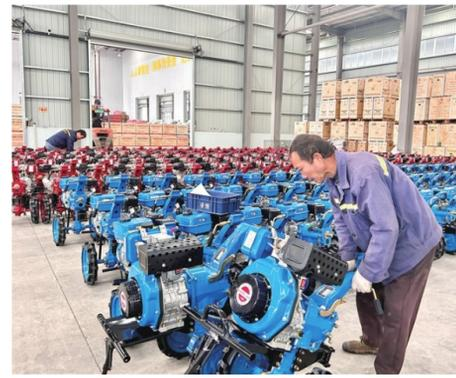
检验人员认真细致对“小黄牛”小型旋耕机进行质检。
