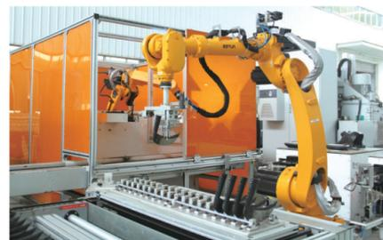
重庆利锋五金有限公司智能化生产车间里，全自动机器人正在对镰刀进行打磨。
