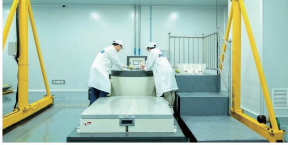
试验工程师们在振动台开展卫星太阳能电池阵试验。 开拓卫星供图
