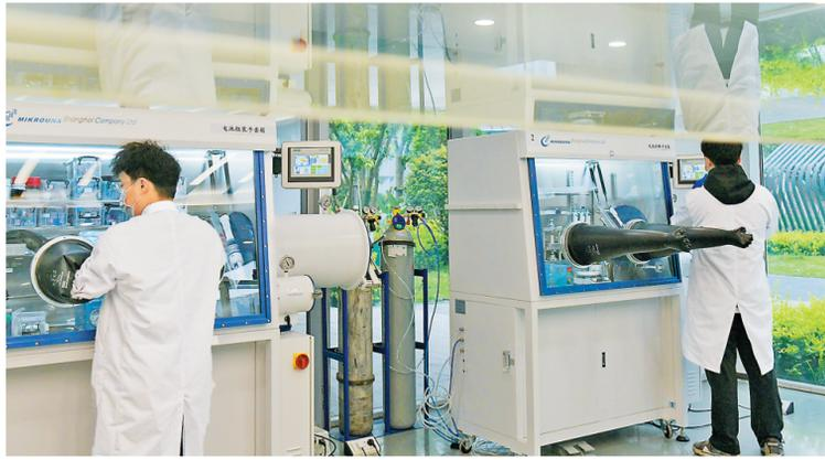
近日，两江协同创新区重庆新型储能材料与装备研究院，研究人员在镁离子电池组架实验室组装电池。
