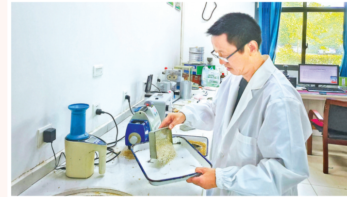
8月19日,铜梁区粮食储备库工作人员对抽样稻谷进行物理检测,判断是否符合储粮标准。 重庆日报记者 栗园园 摄
