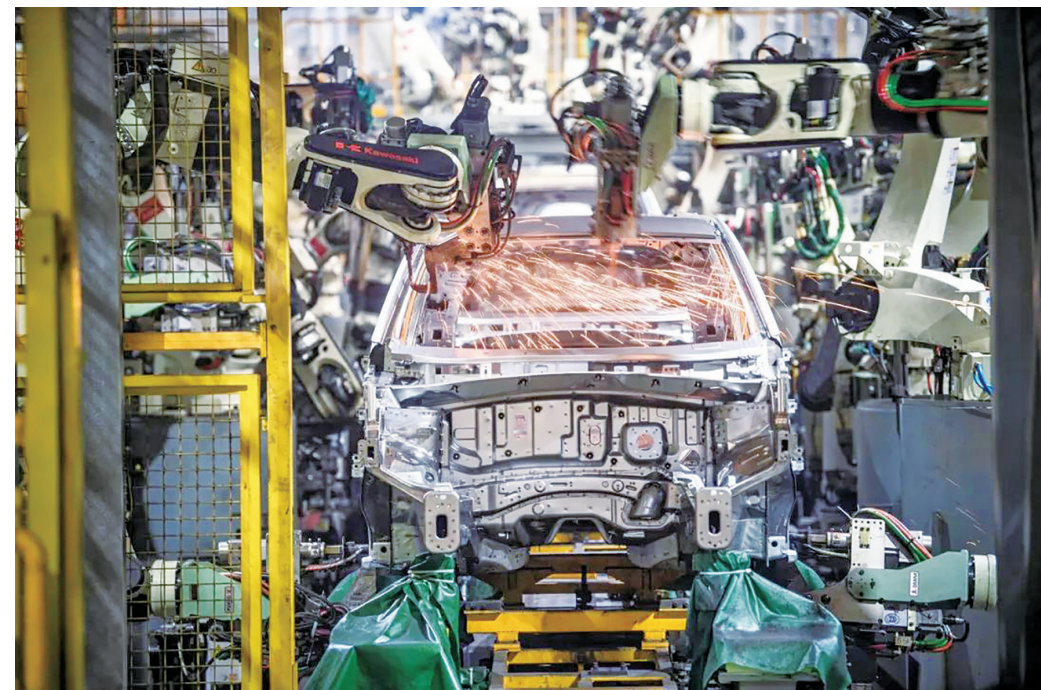
▲长安汽车两江工厂二厂区焊接车间，机械臂正在精准焊接。重庆日报记者 郑宇 摄
