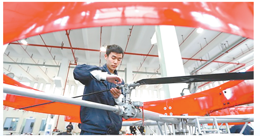
重庆国飞通用航空设备制造有限公司技术人员调试无人机。
