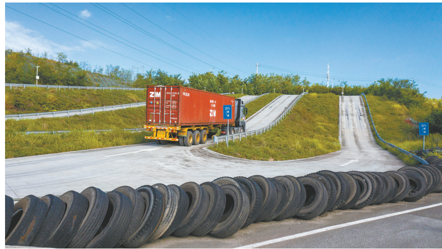
车辆进行爬坡测试。
