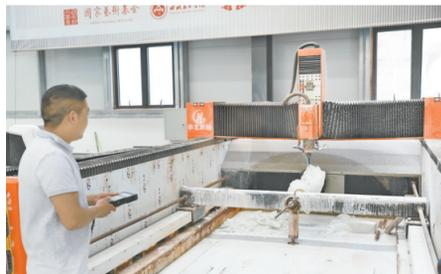
6月6日,大足石刻文创园共享车间内,雕刻师正在操控切割机切割石材。据悉,大足石刻文创园拉动了川渝两地石雕企业集中“抱团发展”,并组建共享车间,提供3D打印机、雕刻机器人、数控圆雕机等石雕石刻设备免费给企业使用,帮助企业降低生产成本,实现资源利用最大化。
