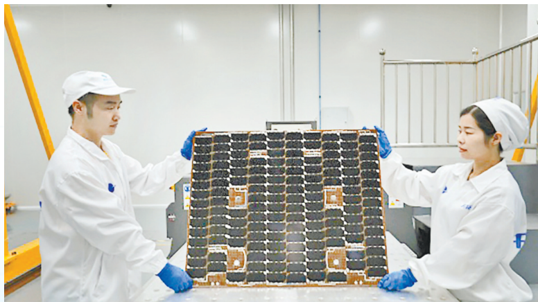
开拓卫星研发人员展示自主研发的太阳电池阵产品。(受访者供图)
