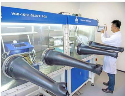
北京理工大学重庆创新中心科研人员正在电池组装实验室，利用手套箱对软包电芯进行注液和封装。重庆日报记者 张锦辉 摄
